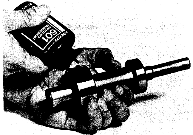
Fig. 8-19, (N10870). Aplicando Loctite a la pista exterior del rodamiento.
