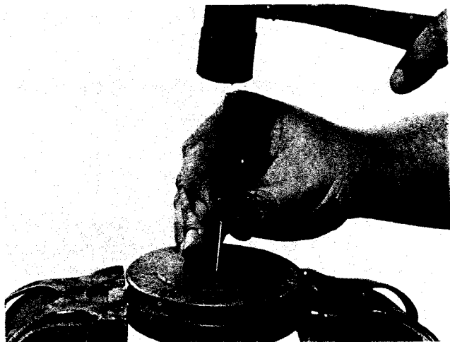
Fig. 8-4, (N10881). Expulsión del conjunto de rodamiento de la polea.
