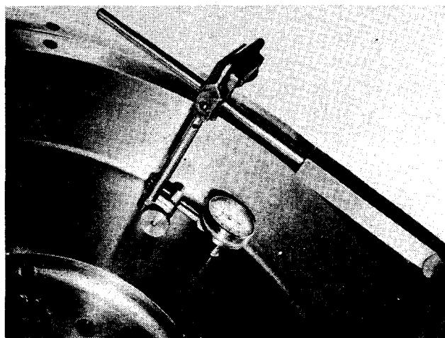
Fig. 14-48, (N114139). Alineación de la cara del embrague del volante.
