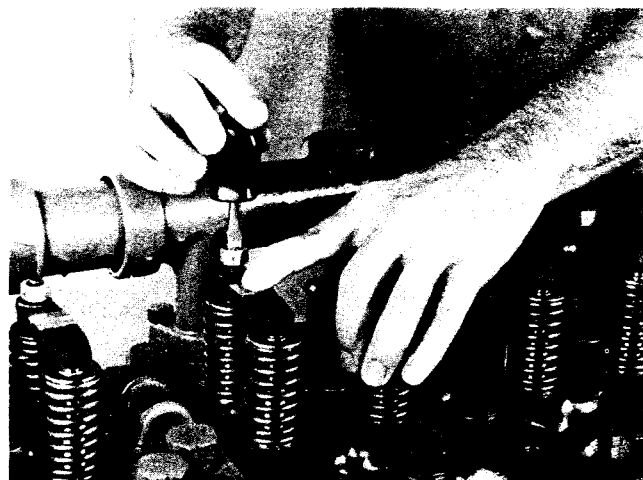
Fig. 14-51, (N114279). Ajuste de crucetas de válvula.
